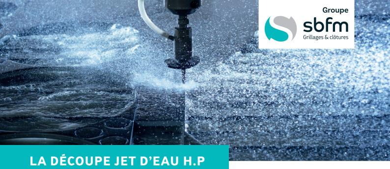
La technologie de découpe au jet d'eau Haute Pression est un procédé de découpe à froid par enlèvement de matière qui fonctionne à l'aide d'un filet d'eau pure ou chargée d'un abrasif en fonction de la densité de la matière, pour découper n'importe quel matériau.
